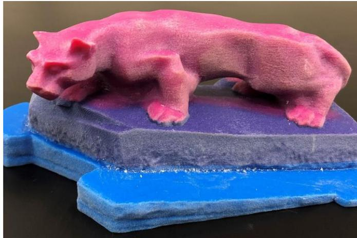
Figura 4. Um objeto produzido com a tecnologia Material Jetting
